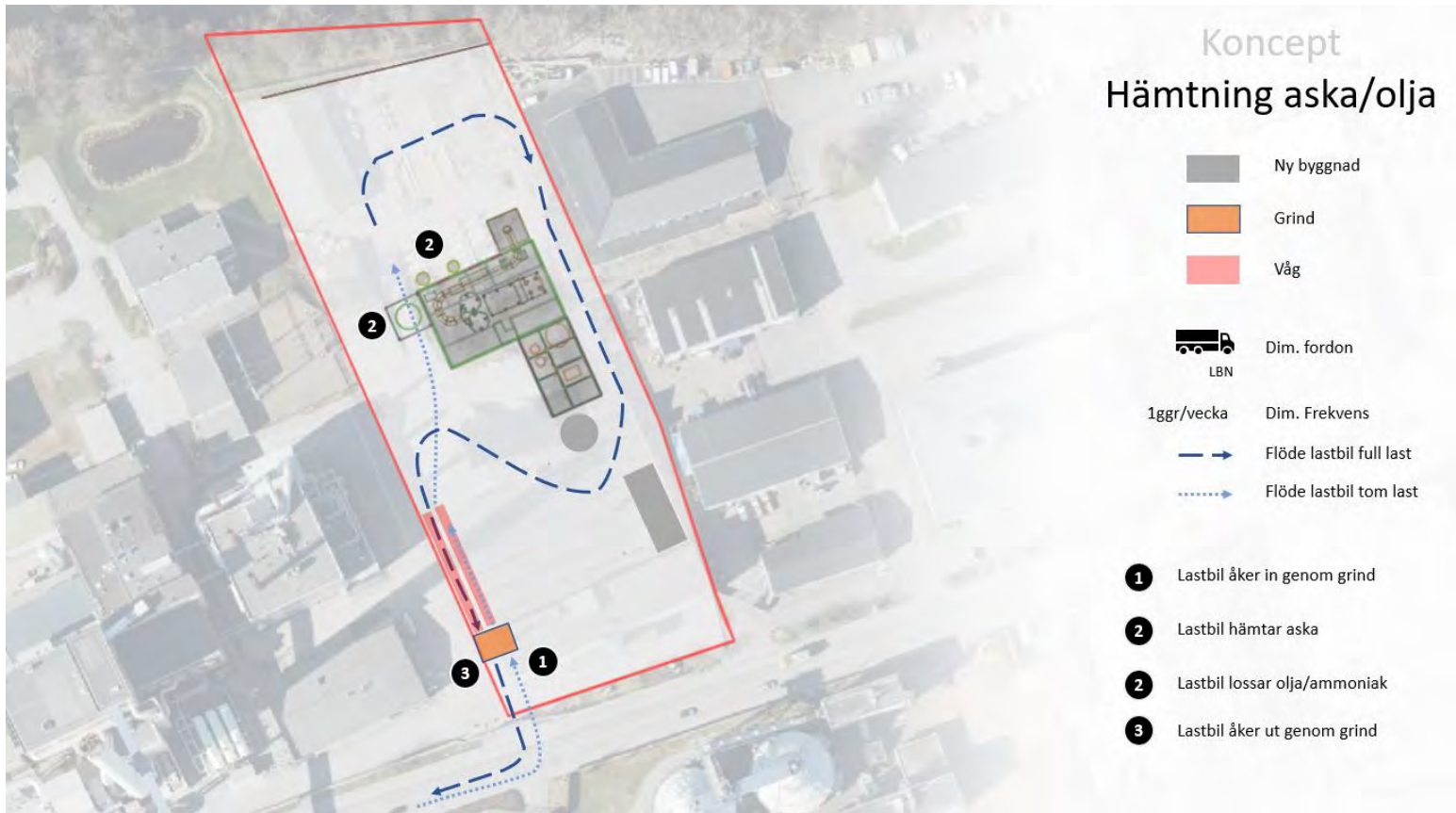
Figur 13 Föreslaget koncept av Ramboll för flödet för hämtning av aska/olja.
