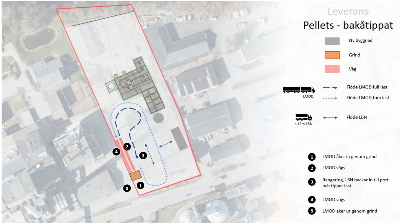
Figur 11 Föreslaget koncept av Ramboll för flöden av pelletsleverans genom bakåttipning.
