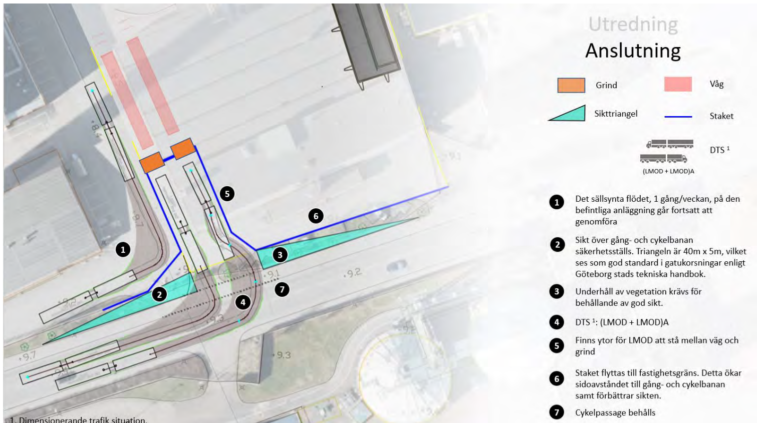
Figur 10 Förslag på lösning kring anslutning till det allmänna vägnätet.
